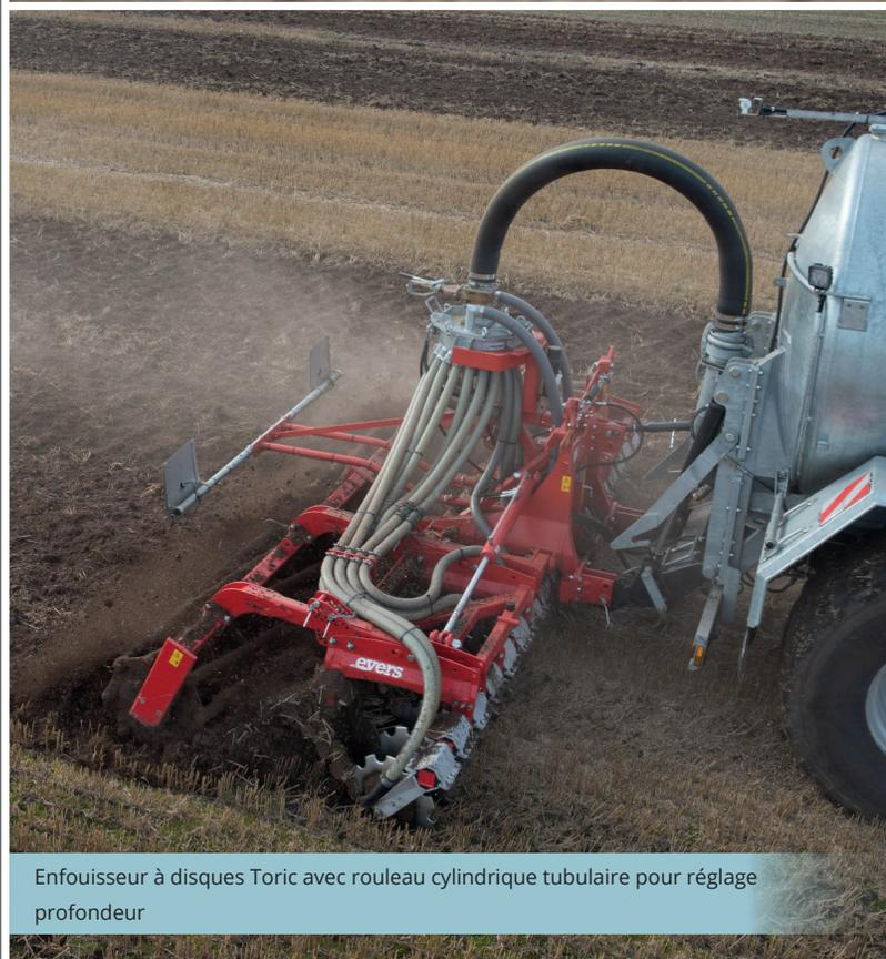
Enfouisseur à disques Toric avec rouleau cylindrique tubulaire pour réglage profondur
