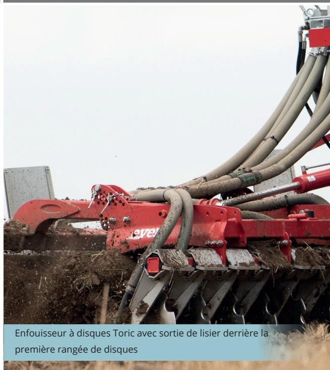
Enfouisseur à disques Toric avec sortie de lisier derrière la première rangée de disques
