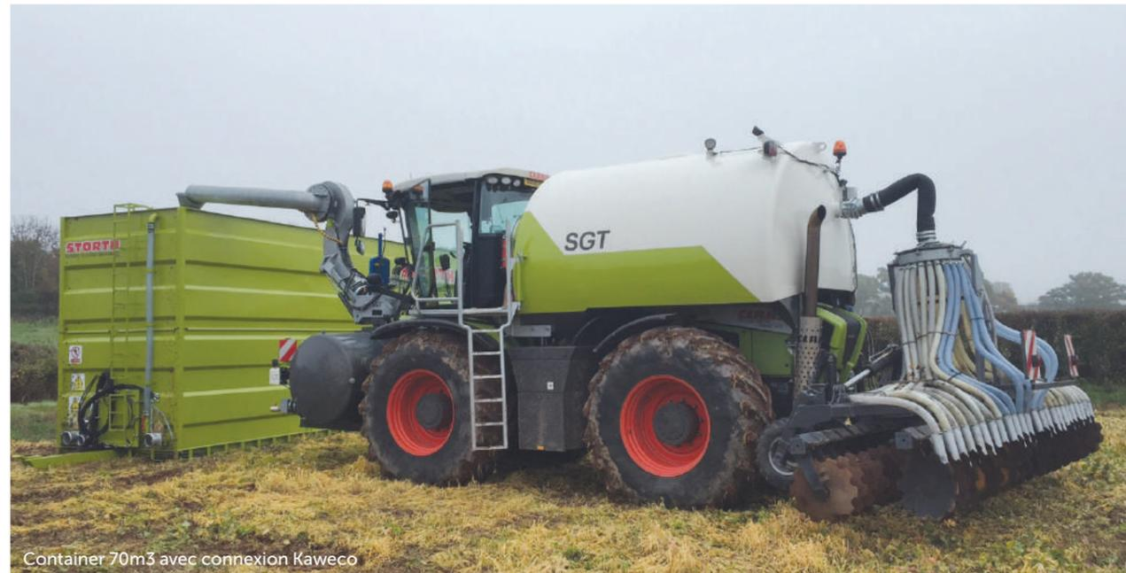
Container 70m<sup>3</sup> avec connexion Kaweco
