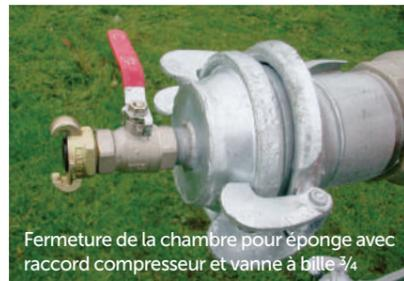
Fermeture de la chambre pour éponge avec raccord compresseur et vanne à bille 3/4
