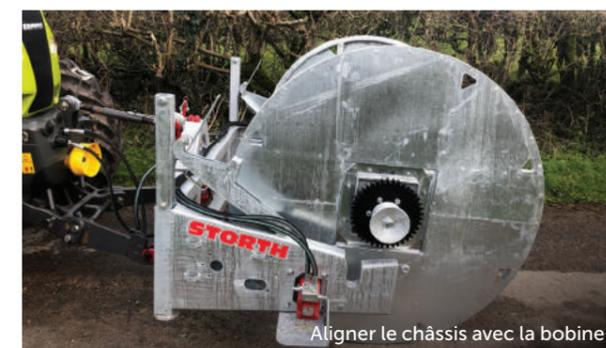
Aligner le châssis avec la bobine
